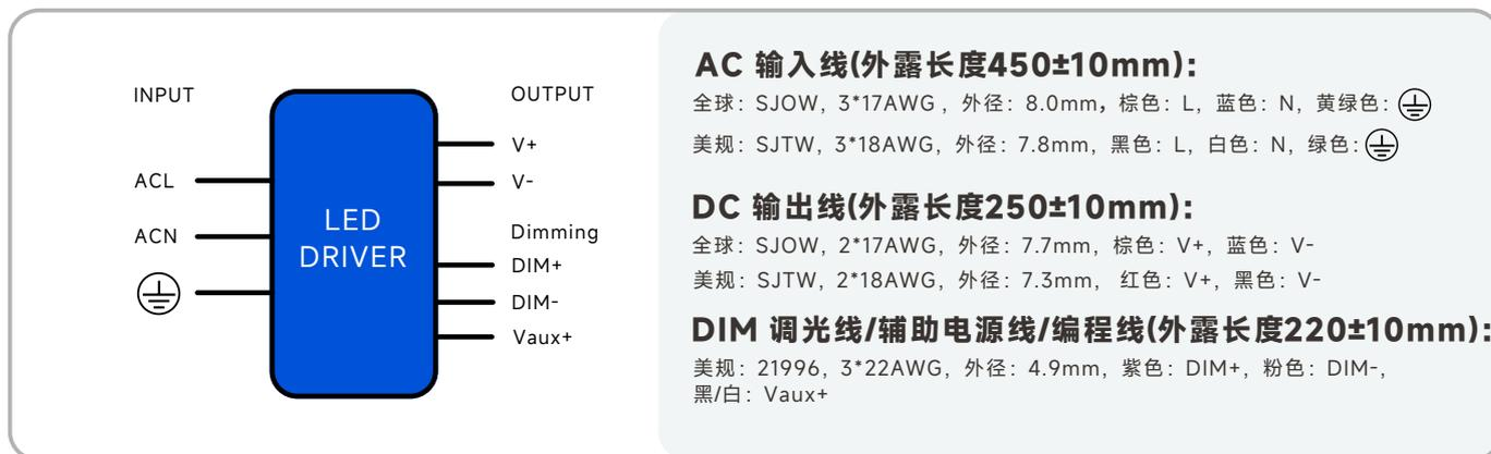
AC输入线, DC输出线, DIM 信号线/辅助电源线/编程线:
